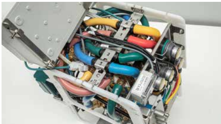
3. ábra: Az alaplapra szerelt fejőegység szükség esetén könnyen hozzáférhető és cserélhető
