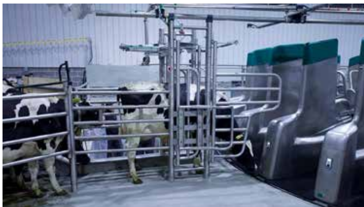
2. ábra: A GEA DairyProQ® automata karusszal bejárata és a robotizált fejőállások
