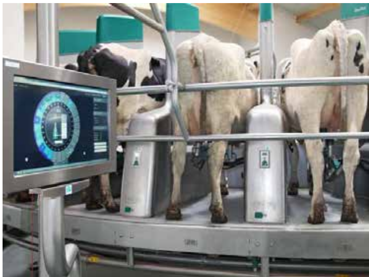
1. ábra: A GEA DairyProQ® munkaállomás, nagyméretű folyamat kijelzőn látható, hogy melyik fejőálláson éppen mi történik
