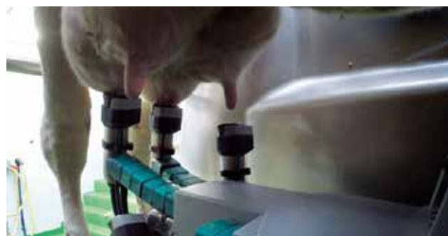
5. ábra: Az optikai szenzorral támogatott GEA robotkar és a tökéletes kialakítású fejőkelyhek biztosítják a gyors felhelyezést és a hatékony fejést
