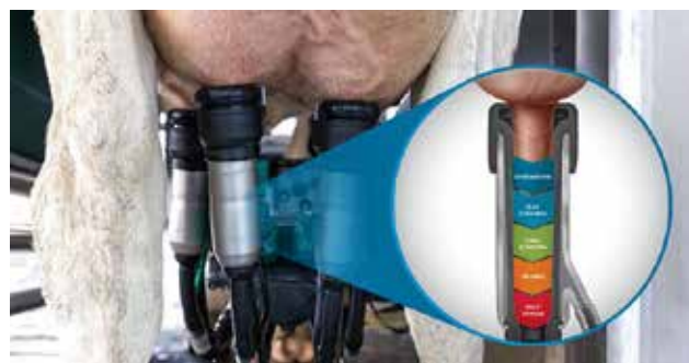
4. ábra: A GEA fejőrobotok a fejést egy menetben végzik el, minden munkafolyamat a fejőkehelyben történik, ezzel jelentősen javul a fejés hatékonysága
